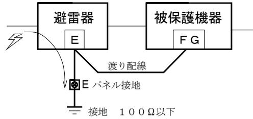
保護したい機器のフレームグランド端子FGを避雷器の端子Eに接続してからパネルの接地端子に接続すると被保護機器に誘導雷サージが及ばなくなります。
