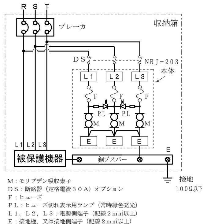
本器は、屋外ケーブルから受変電設備などを通過してきた誘導雷サージを吸収し、電源設備機器を保護する、交流電源用モリブデン避雷器です。
