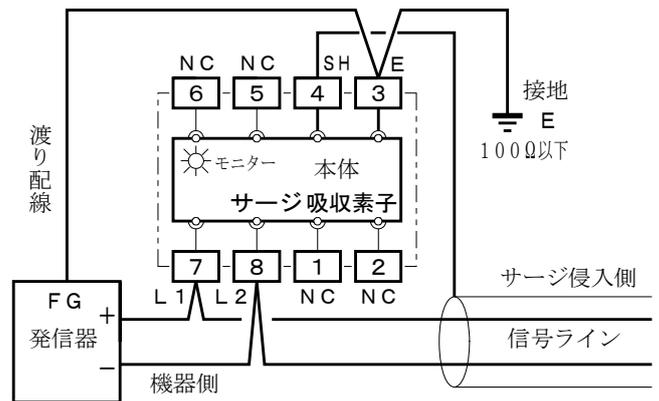
L1, L2：ライン端子 SH：シールド線 E：接地端子（D種接地）
