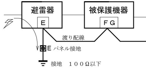
保護したい機器のフレームグラウンド端子を避雷器の端子Eに接続してからパネル接地端子に接続すると被保護機器に誘導雷サージが及ばないようになる。
