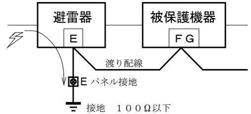
保護したい機器のフレームグラウンド端子を避雷器の端子Eに接続してからパネル接地端子に接続すると被保護機器に誘導雷サージが及ばないようになる。
