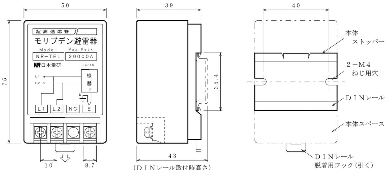
本器は、電話、ファクシミリなどの屋外ケーブルを通過してきた誘導雷サージを吸収し、電気通信機器を保護する、電話回線用モリブデン避雷器です。
