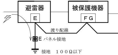
保護したい機器のフレームグランド端子を避雷器の端子Eに接続してからパネル接地端子に接続すると被保護機器に誘導雷サージが及ばないようにする。
