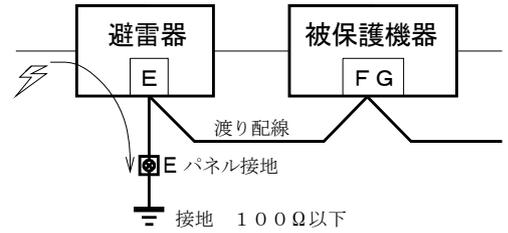
保護したい機器のフレームグラウンド端子を避雷器の端子Eに接続してからパネル接地端子に接続すると、被保護機器には雷サージが及ばなくなります。
