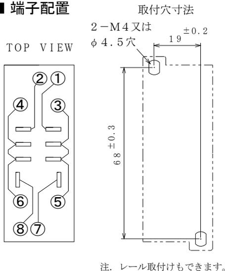
本器は、屋外ケーブルから受変電設備を通過してきた誘導雷サージを吸収する交流電源用避雷器です。省スペースでDINレールに取り付けられる構造で小容量電子機器の保護に最適です。
