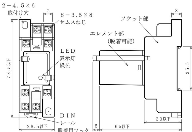
本器は交流電源のケーブルに生じた誘導雷サージを吸収し、電子機器を保護する避雷器です。内蔵のヒューズはエレメントの短絡時電源に影響をあたえないために設けてあります。
