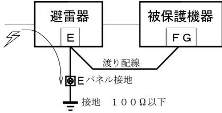
保護したい機器のフレームグランド端子を避雷器の端子Eに接続してからパネルの接地端子に接続すると、被保護機器に誘導雷サージが及ばなくなります。
