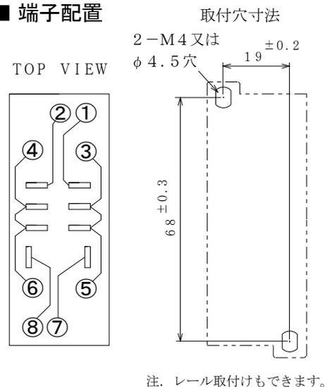
本器は、屋外ケーブルから受変電設備を通過してきた誘導雷サージを吸収する交流電源用避雷器です。省スペースでDINレールに取り付けられる構造で小容量電子機器の保護に最適です。
