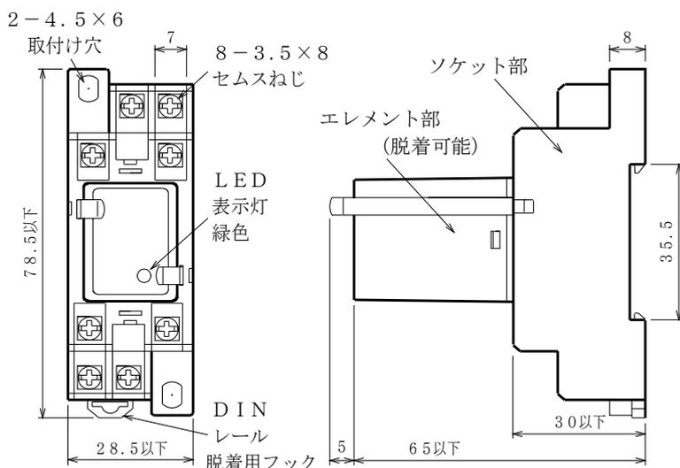
本器は交流電源のケーブルに生じた誘導雷サージを吸収し、電子機器を保護する避雷器です。内蔵のヒューズはエレメントの短絡時電源に影響をあたえないために設けてあります。
