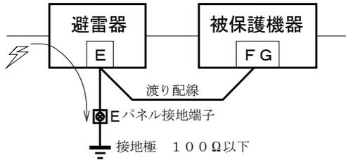
保護したい機器のフレームグランド端子を避雷器の端子Eに接続してからパネルの接地端子に接続すると、被保護機器に誘導雷サージが及ばなくなります。
