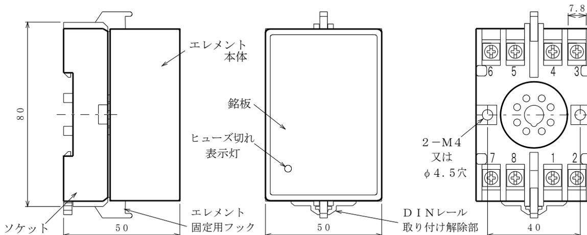
本器は直流電源のケーブルに生じた雷サージを吸収し、バックアップ電源を保護する避雷器です。温度ヒューズを内蔵し、万一エレメント短絡時の事故を防止するように考慮しています。
