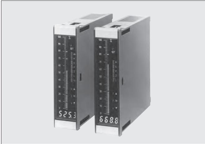
**1933**はバーグラフメータにH、Lの2点設定のコンパレータを、**1934**はバーグラフメータにHH、H、L、LLの4点設定のコンパレータを付加したデジタル表示付バーグラフメータリレーです。設定値の設定やデジタル表示のスケール機能などの操作機能を前面部に設けていますので、初期設定や変更が簡単にできます。
