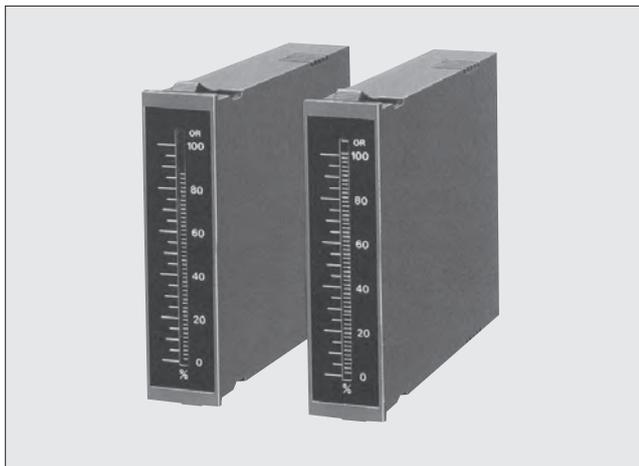
1921は51バータイプの小形バーグラフメータです。外形は、72×18mmの小形DINサイズ設計です。スナップインパネルマウント方式の採用により、パネルにワンタッチで取り付けができます。表示は鮮明な赤色LEDで、オーバー入力表示付です。
