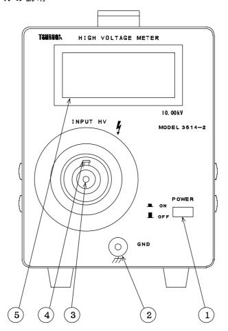
電源スイッチ(POWER) スイッチを押し込むと本体電源がONとなります。
