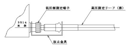
抜止金具のU字溝側を本体の低圧側測定端子に締めつける
