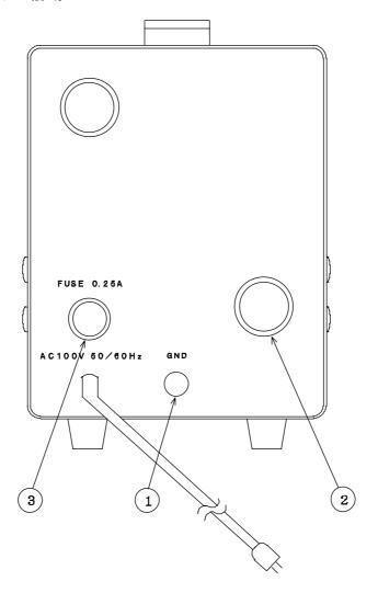
大地接地端子(GND) 箱体を大地に接地する端子です。
