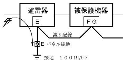
保護したい機器のフレームグランド端子FGを避雷器の端子Eに接続してからパネルの接続端子に接続すると、被保護機器に誘導雷サージが及ばなくなります。
