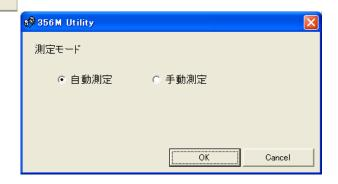
自動測定 : CH1 から設定した測定最大チャンネルまでを設定された周期で測定
