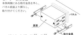
パネルカット寸法:92  $^{+0.8}_{\phantom{0}0}$  × 45  $^{+0.6}_{\phantom{0}0}$  mm
