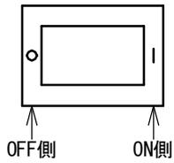
裏面パネルの電源スイッチが **OFF** になっている事を確認後、電源プラグをコンセントに接続し、電源スイッチを **ON** してください。
