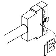
裏面パネルの測定コネクタに測定ケーブル（オプション）を接続します。測定ケーブルは1本につき5CH分ですので、20CH測定するには4本すべて接続してください。
