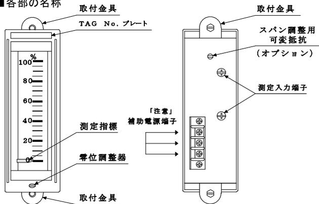
「注意」 補助電源端子は、受信指示計（DC 1～5V計で入力インピーダンスが1MΩ以上を指定の時）に設けています。
