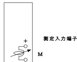
端子ねじの適正締め付けトルク: 0.36~0.48N・m
