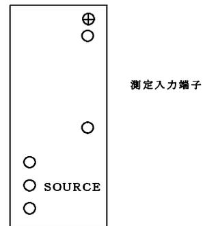
M5 端子ねじの適正締め付けトルク：1.2～1.3N・m
