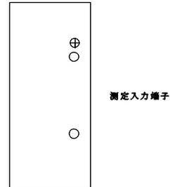
端子ねじの適正締め付けトルク：1.2~1.3N・m
