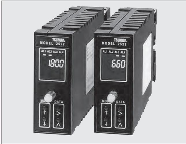
**2522、2532** は、2点または4点の警報を内蔵した温度センサ入力のディテクトリレーで警報点や测温センサの選択などすべての設定が前面スイッチで行える操作性重視設計です。警報出力は上限または下限の任意設定が可能で、出力形態もリレー出力またはオープンコレクタ出力の指定ができます。また、コンパクトなプラグインケースに収納しておりますので、設置スペースの削減に威力を発揮します。各種機器・装置の温度制御や過熱・過冷保護などに適しています。
