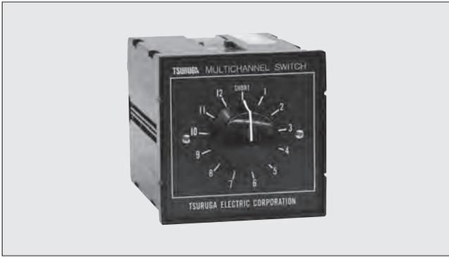
6500-01は、抵抗式および熱電式の温度指示計に接続し、12点の温度を集中監視のため、切替指示させる場合に使用する切替器です。多点切替器を使用することにより、パネル占有面積が、大幅に削減できます。
