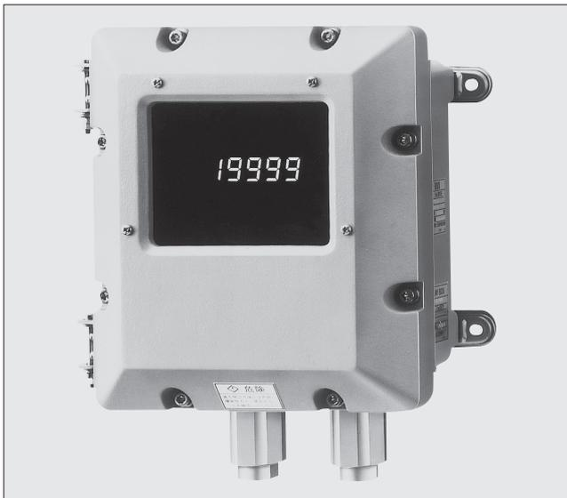
EX1R-D10は、爆発性ガスが容器内に侵入し、万一爆発しても容器は爆発圧力に耐え、かつ外部の爆発性ガスに引火するおそれがない構造になっています。危険場所での流量、圧力、温度等の状態を現場で確認できます。
