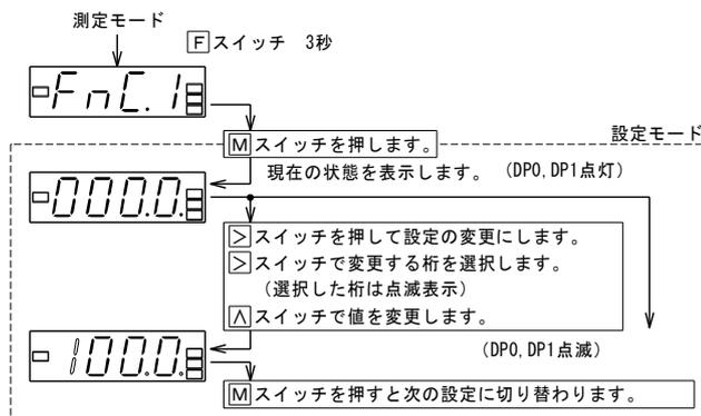
・オフセット表示とは 0mV(V,  $\mu$ A, mA, A)入力時の表示を示します。
